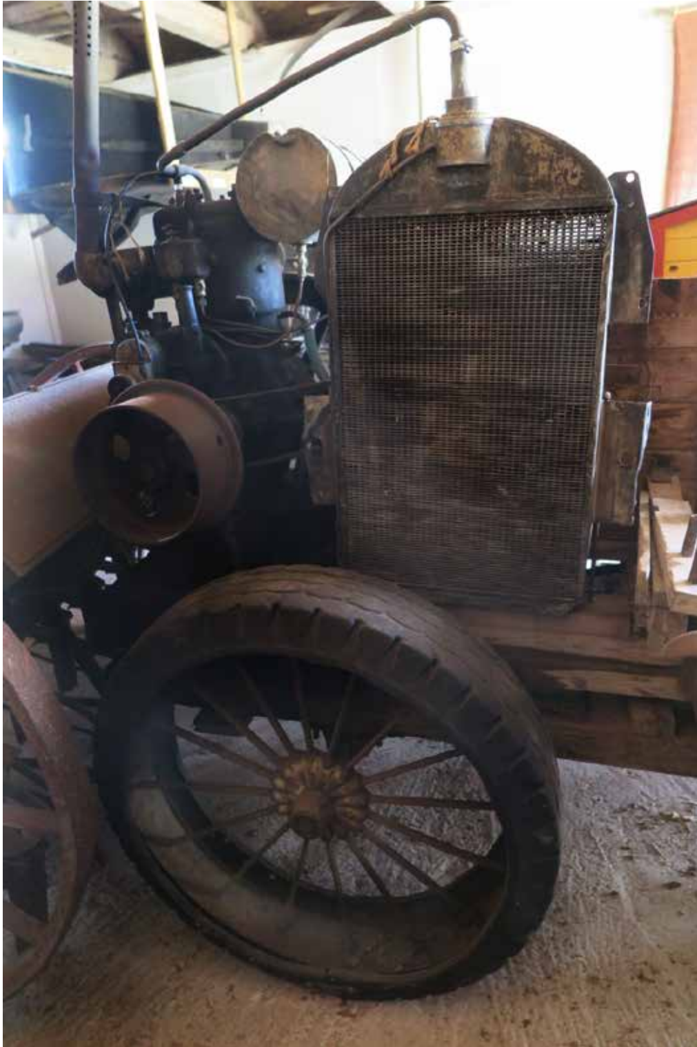
Här syns motorn som beskrivits i texten ovan. Strax över däckets syns remskivan som drev remmen till sågklingan.
